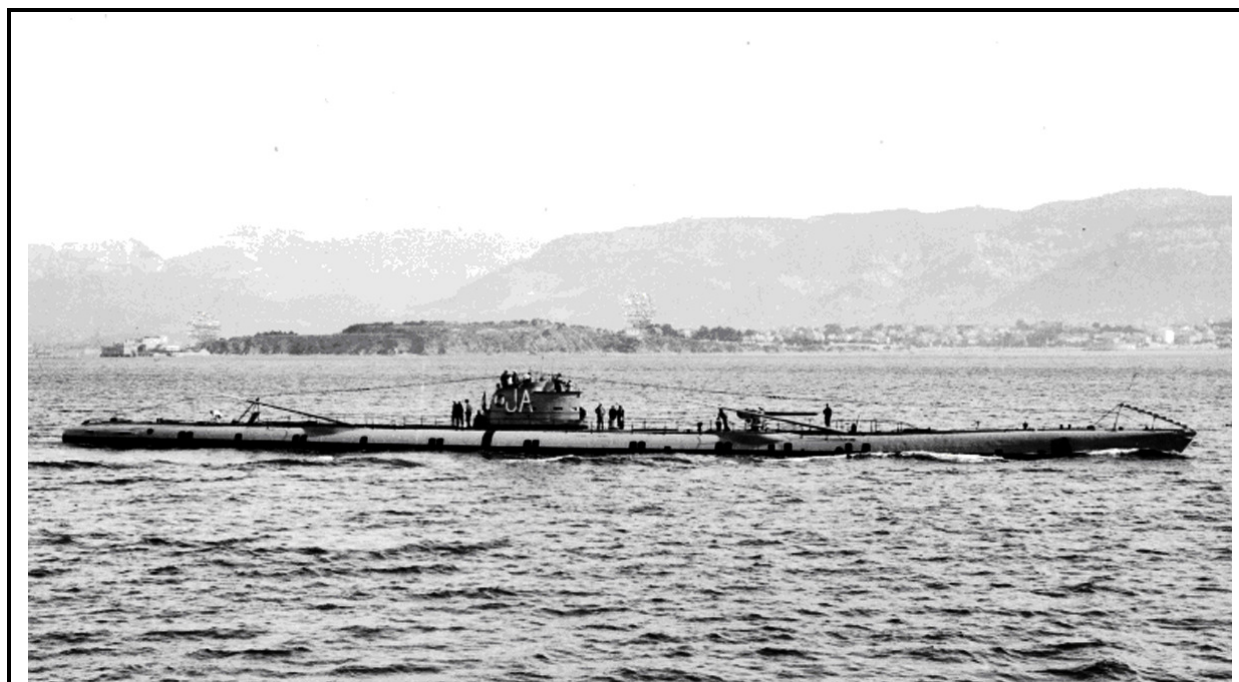
1 : U.105, rebaptisé « Jean Autric », fait partie des 46 sous-marins allemands remis à la France après d'après négociations entre alliés. La Marine nationale en remet 10 en service : 838 t en surface, 1000 t en plongée. Autonomie : 3 900 nautiques (7 222 km) et une vitesse de 16 nœuds en surface, une autonomie de 50 nautiques et une vitesse de 5 nœuds en plongée. Motorisation : 2 diesels MANDE 1100hp, 1 moteur électrique Siemens-Schuckert de 788 hp. Armement : 6 tubes lance-torpilles de 500 mm(4 à l'avant, 2 à l'arrière), 16 torpilles ; 1 canon de 10,5 cm SKL/45 + 140 coups, 1 canon de 8,8 cm. Equipage : 4 officiers, 35 sous-mariniens. Cliché : Marius BAR – Toulon.
