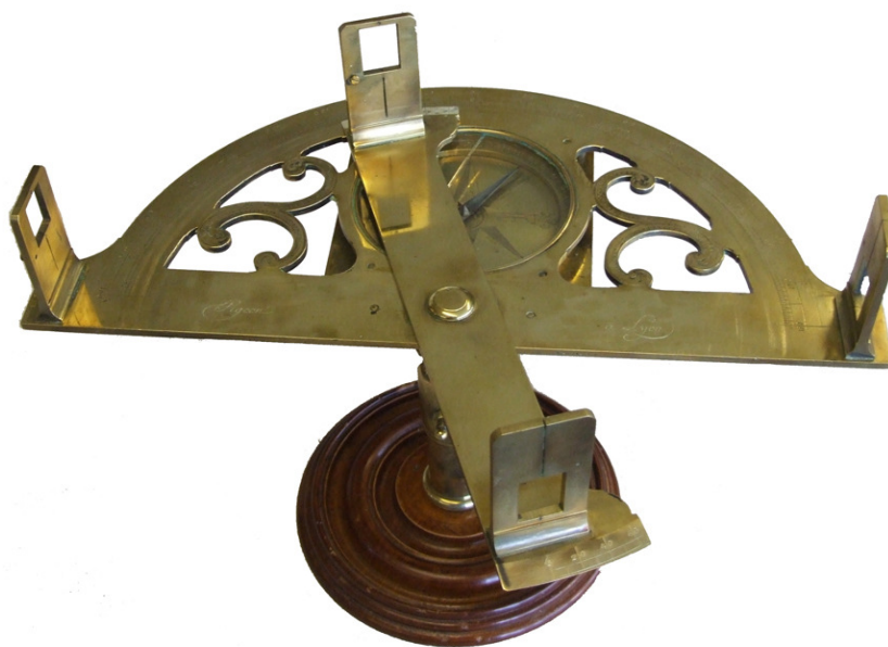
Figure 5 : Pigeou, graphomètre à pinnules (vers 1780), Musée du patrimoine et de la mesure (Mairie de La Talaudière)
