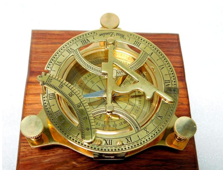
Figure 1 : Boussole marine à cadran solaire du XVIII e siècle permettant de corriger la déclinaison magnétique
