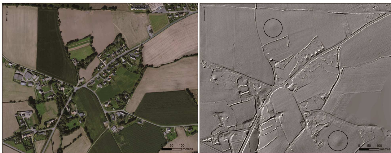
Figure 4 : Orthophotographie IGN de 2015 du secteur de Kerhuel à Rospez (à gauche) et ombrage simple depuis un MNT_1m (HS A315 H35).
